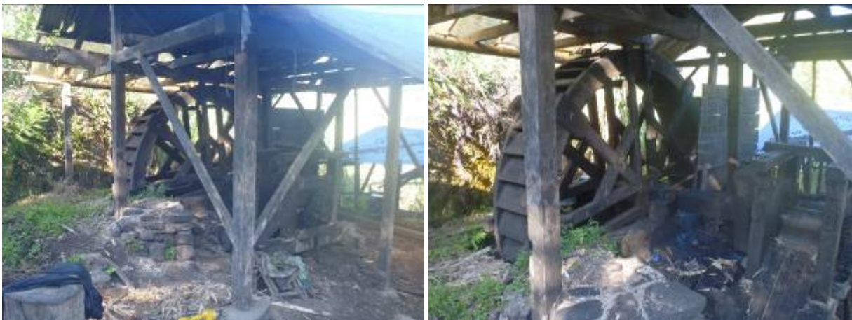
Figura 10: Molino Hidráulico: Compuesto por el molino y trituradora: Se activa bajo la fuerza de la caída del agua, la cual pone en acción el molino y este a su vez la trituradora.
