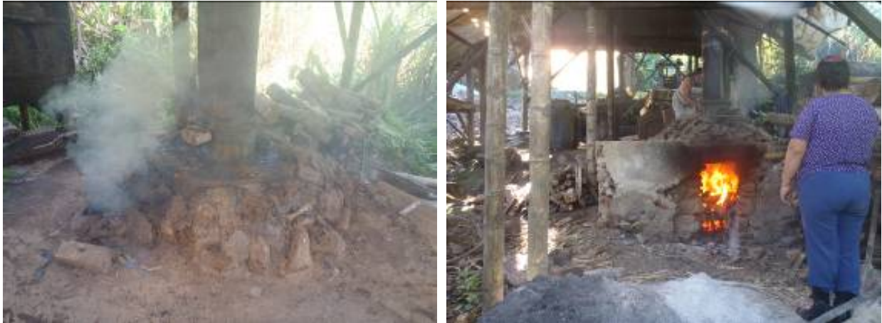
Figuras 15- 16: Alambique de cobre: enterrado bajo tierra, con horno para destilación del aguardiente.
