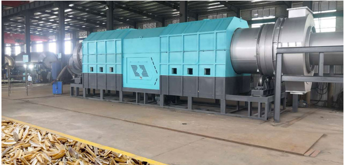
Figura 4. Maquinaria de secado de granos de arroz que usan cascarilla como combustible
