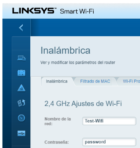
Ilustración 5 Clave configurada en el router
