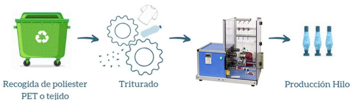
*Ilustración 3* Proceso para obtener el hilo PET
