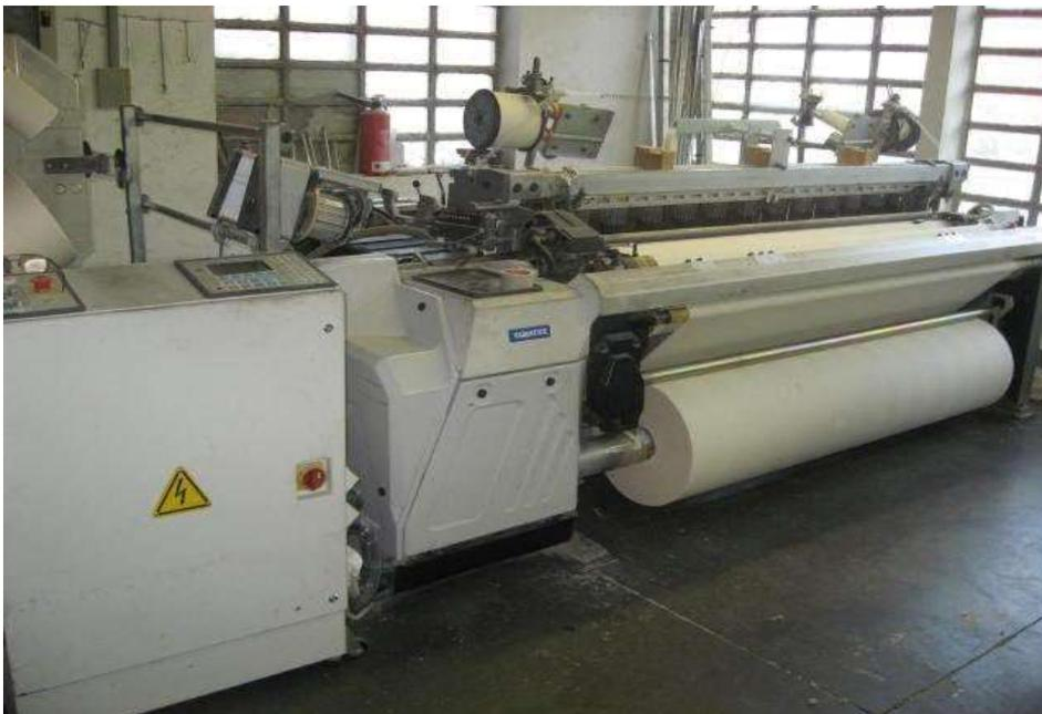
*Ilustración 8* Telar Plano Vamatex electrónico P1001
